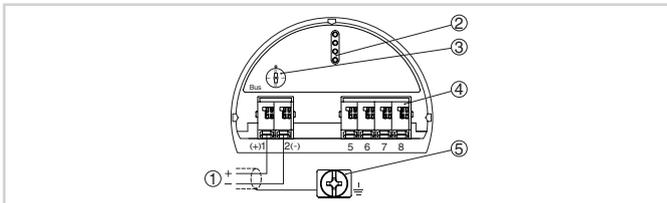
Отсек электроники и подключения (однокамерный корпус)
